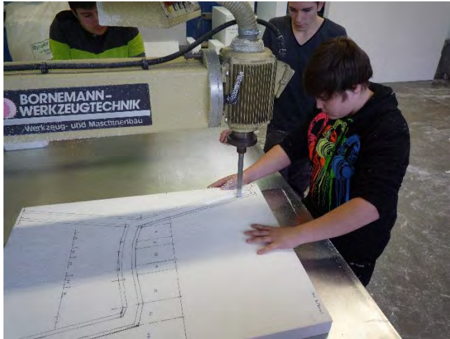
(Bild 4) Fräsen der Fugen unter Aufsicht von Maik Ledwig
