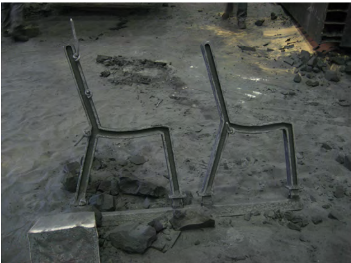
(Bild 11) Zeigt die noch nicht bearbeiteten Gestelle, direkt nach dem Ausformen
