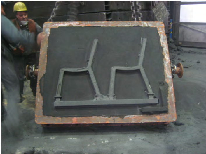
(Bild 2) Diese Bild zeigt die gegossenen Parkbankuntergestelle noch im Formkasten liegend
