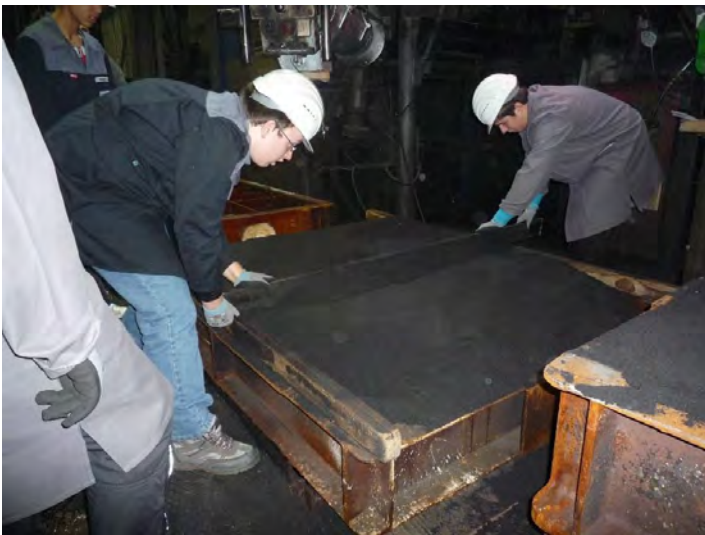
(Bild 8) Abziehen des Sandes auf dem Formkasten
