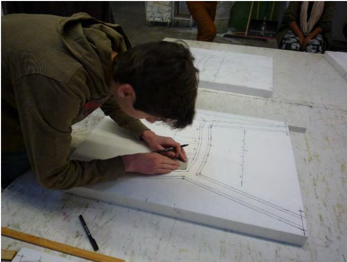
(Bild 3) Dieses Bild zeigt das Aufzeichnen der Form auf Styropor
