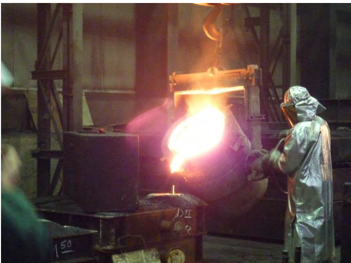
(Bild 9) Befüllen des Formkastens mit flüssigem Eisen
