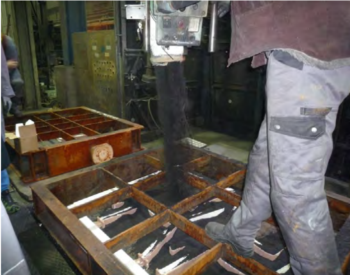
(Bild 7) Befüllen des Formkastens mit Formsand
