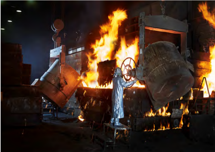
(Bild 10) Gießen eines Gussteiles mit ca. 17 Tonnen
